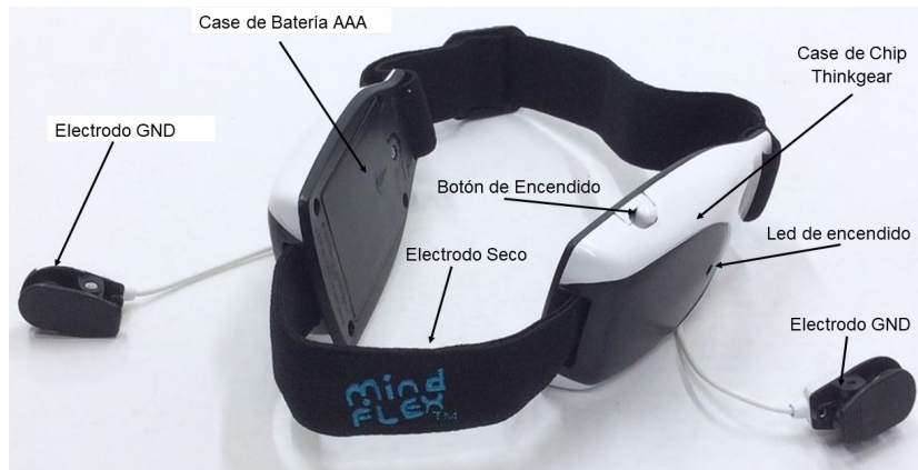
Fig. 2. Diagrama de los componentes de la Diadema Mindflex.
